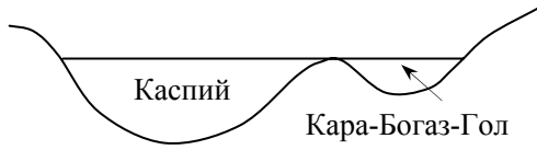
Рис. 7.3. Профиль дна водоема, залива и соединяющего их узкого пролива
